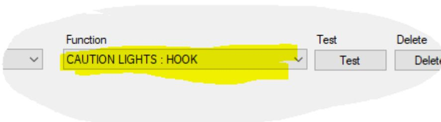
A coluna "Função" corresponde à função do lightBit no simulador Falcon BMS. Aconselho a testar para usar uma função simples como o "Hook" ou "Seat Armed" que ilumina imediatamente o PFL.
