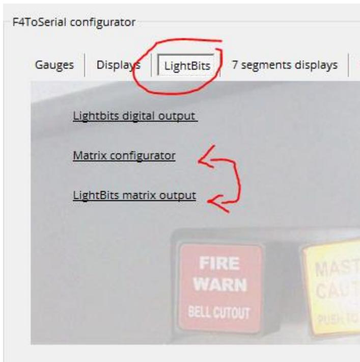
Existem 3 links neste separador. O primeiro link "LightBits digital output" é usado para conectar os LEDs diretamente na placa. Os outros dois são usados para criar e configurar uma matriz.
